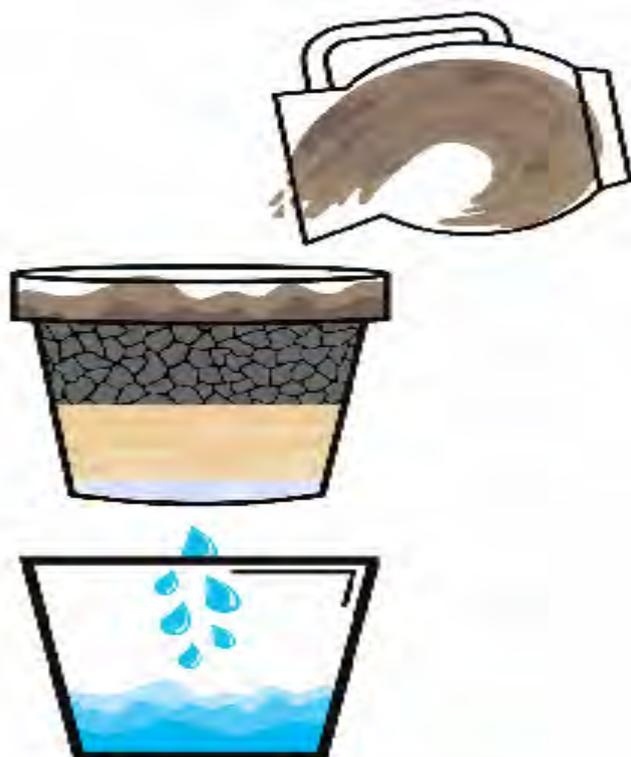
**Esempio di depuratore.** Gli strati presenti nel vaso, simulando gli strati del suolo depurano l'acqua dalle impurità.
