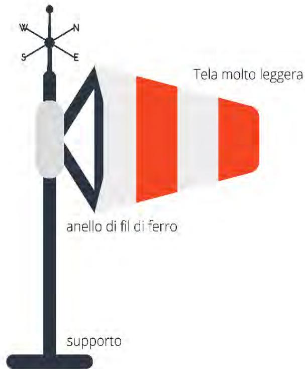
**Esempio di manica a vento.** È uno strumento che serve per determinare l'intensità e la direzione del vento a bassa quota
