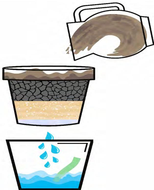
**Esempio di depuratore.** Gli strati presenti nel vaso, simulando gli strati di un suolo con rocce basiche depurano l'acqua dalle impurità e la arricchiscono di bicarbonati. Il pH dell'acqua varierà leggermente, pertanto la cartina tornasole virerà.
