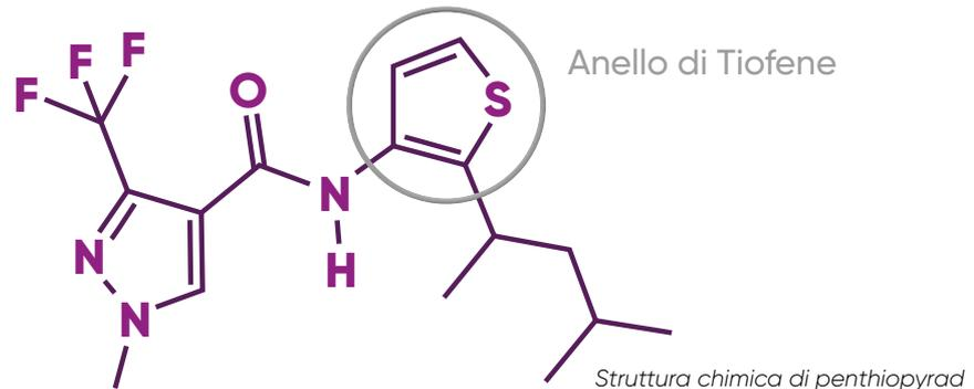
A livello molecolare, *penthiopyrad* possiede una caratteristica peculiare, definita anello di Tiofene, in grado di garantire la penetrazione rapida della sostanza attiva all'interno della cellula del fungo patogeno, portandola alla degenerazione.
