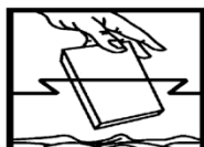
3) Introdurre i sacchetti nell'atomizzatore e mettere in funzione l'agitatore
